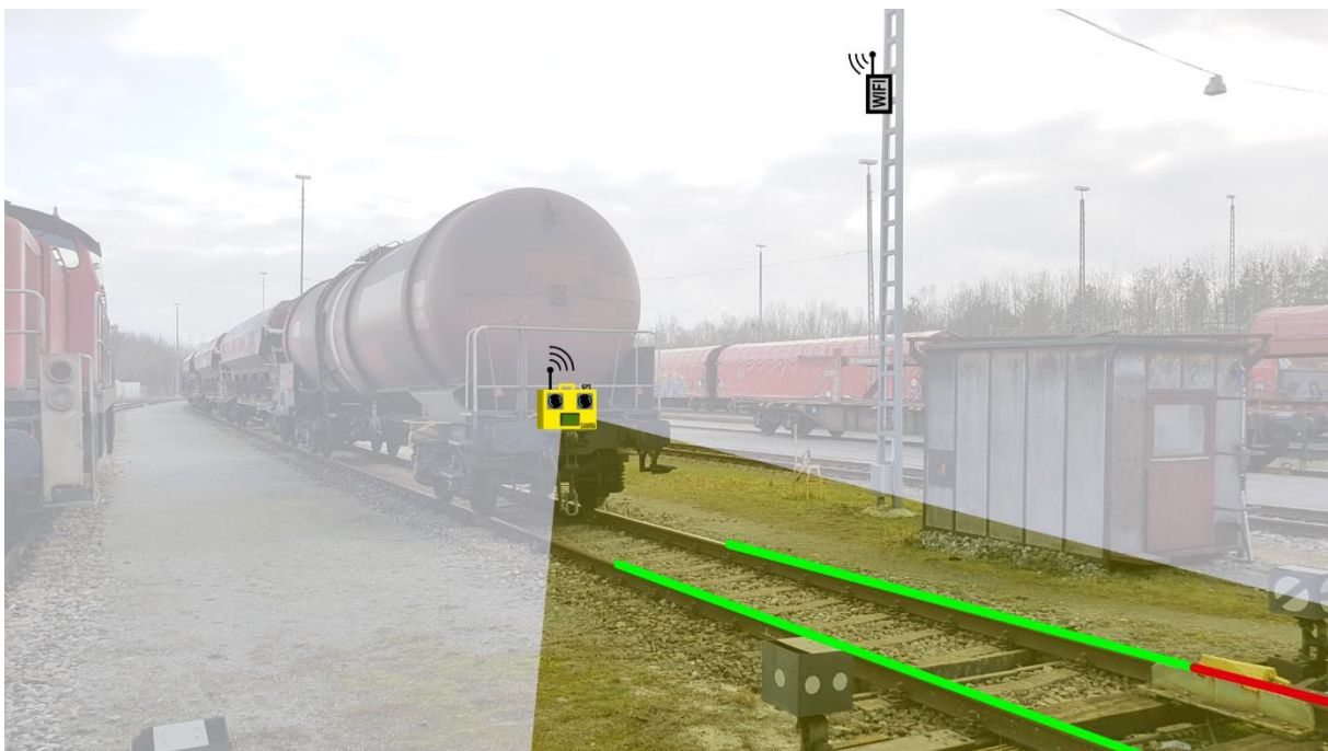
Abb. 2 - SAMIRA mobil wird temporär auf dem Zughaken des letzten Wagens montiert und überwacht den Fahrweg
