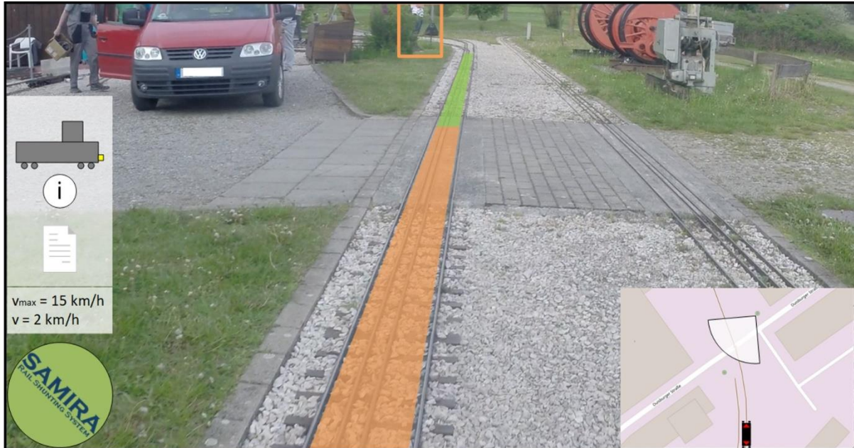
Abb. 4 – Human Machine Interface mit Live-Video und Augmented Reality, erkannte Person wird mit oranger Bounding Box hervorgehoben
